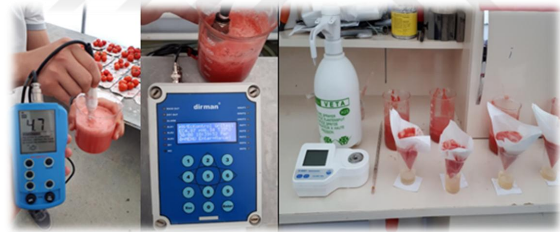
Şekil 3.13. Domates meyvelerinde EC, pH, SÇKM ve titrasyon asitliğinin belirlenmesi
