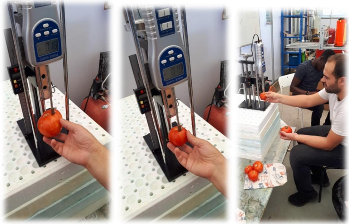
Şekil 3.11. Genotiplerde meyve sertliği ölçümü
