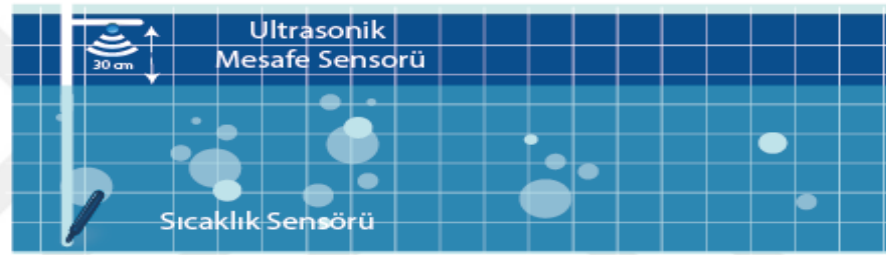
Şekil 3.13 Kablosuz havuz ünitesi tasarımı
