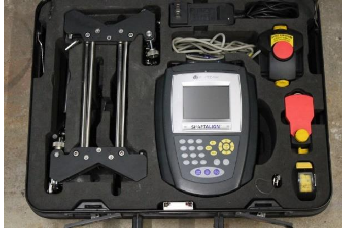
Şekil 3.33. Pruftechnik Shaftalign OS3 motor mili hizalama cihazı
