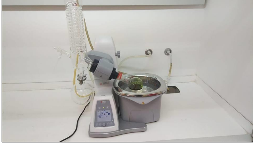
Şekil 3.23. Bitki ekstraktı (özüt) için, düşük basınç altında 45 °C'de vakum buharlaştırıcı (evapratör) kullanılarak konsantre (yoğunlaştırma) (Orijinal)
