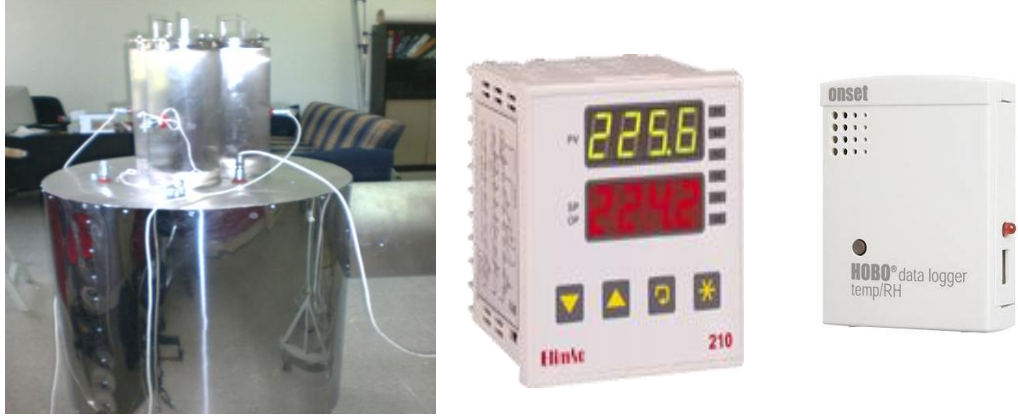
Şekil 3.6. Sıcaklık ölçüm noktaları, kontrol ünitesi, sıcaklık-bağıl nem kaydedici
