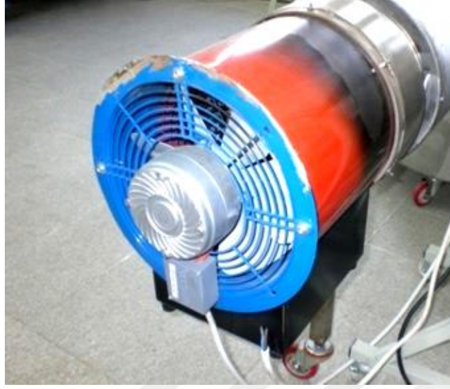
Şekil 3.3. Hassas kurutucuya ait fan ve ısıtıcı ünitesi
