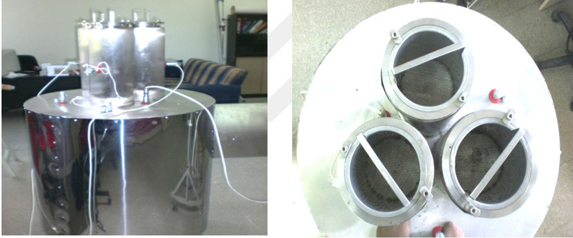
Şekil 3.4. Hassas kurutucunun kurutma kanalları ve ürün kabı
