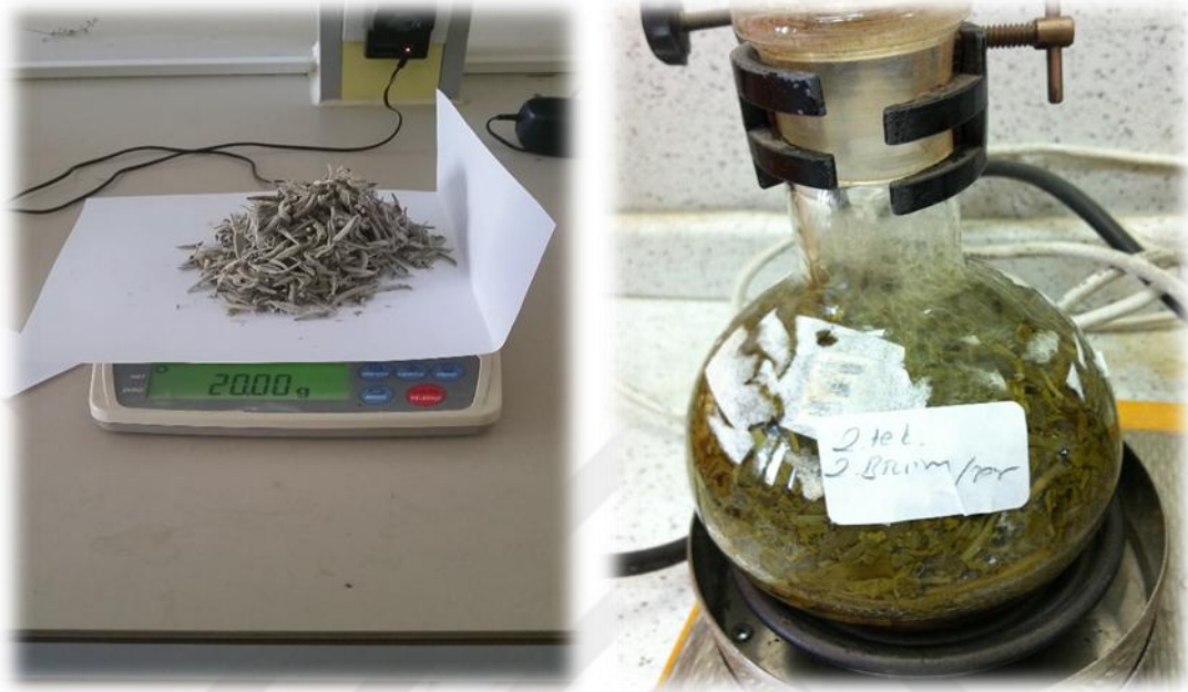
Şekil 3.4. Uçucu yağ eldesi a) Örneklerin tartılması b) Clevenger cihazında distilasyon
