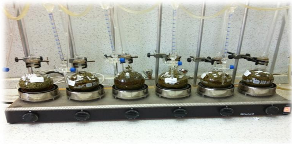
Şekil 3.5. Adaçayı bitkisinden clevenger cihazı ile uçucu yağ elde edilmesi
