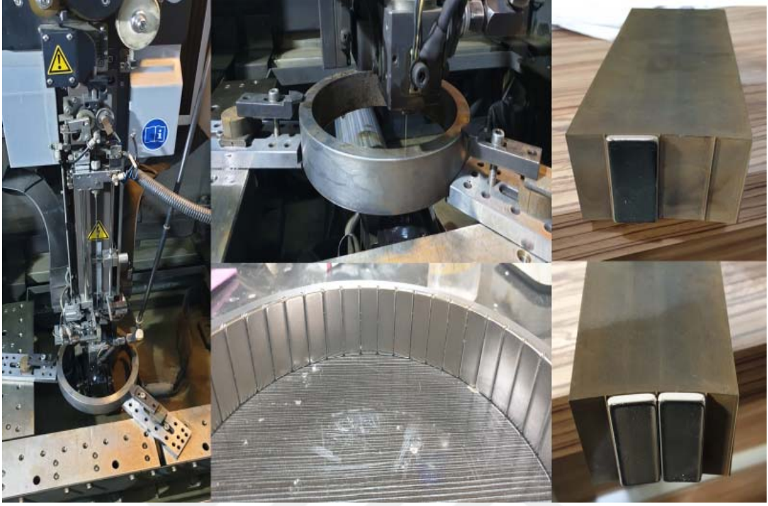
Şekil 3.13. Prototip motor rotor üretim ve mıknatıs yerleşimi
