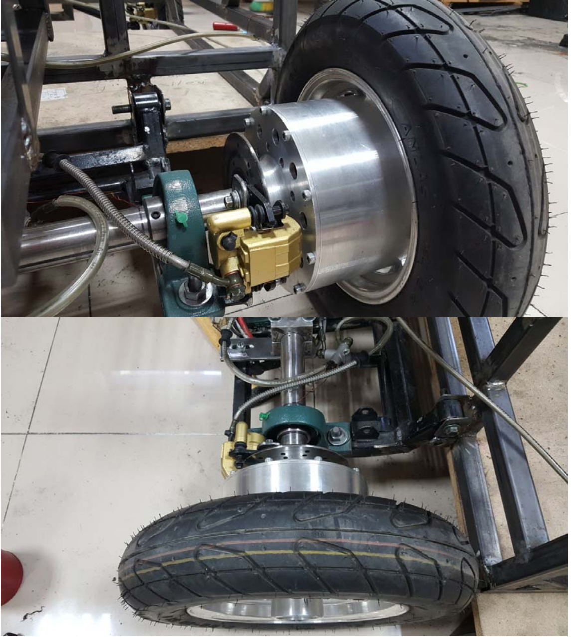
Şekil 4.26. Motorun araca entegre edilmesi
