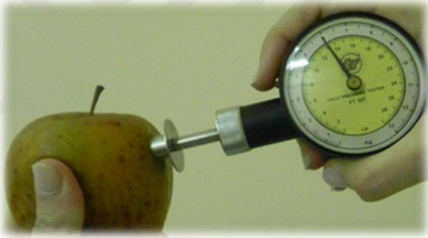
Şekil 3.8. Penotrometre ile meyve eti sertliği ölçümü
