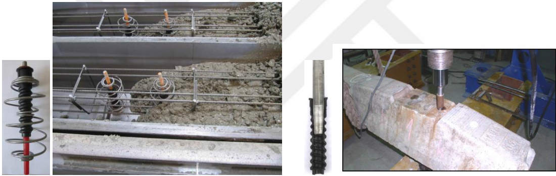
Şekil 2.67. Solda: Önerilen kesme donatıları, Sağda: Széchenyi István University’de uygulanan dübel şişirme testi (Németh, 2016)
