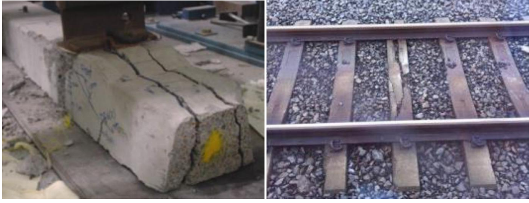
Şekil 2.71. Solda: Laboratuvar darbe deneyi esnasında meydana gelen hasar, Sağda: Demiryolundaki traverslerde darbe etkisiyle meydana gelen hasar örneği (Ferdous ve Manalo, 2014)
