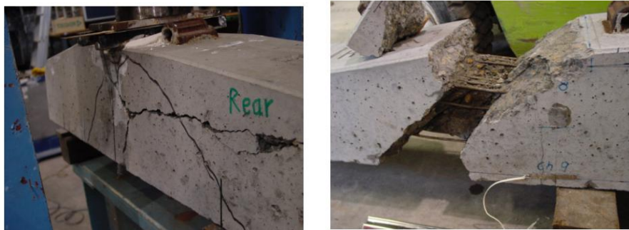
Şekil 2.36. 600 kN'luk darbe yükü ardından traversde meydana gelen çatlaklar (solda) ve darbe deneyi ardından yapılan statik yükleme testi sonunda donatıların durumu (sağda) (Remennikov ve Kaewunruen, 2007)
