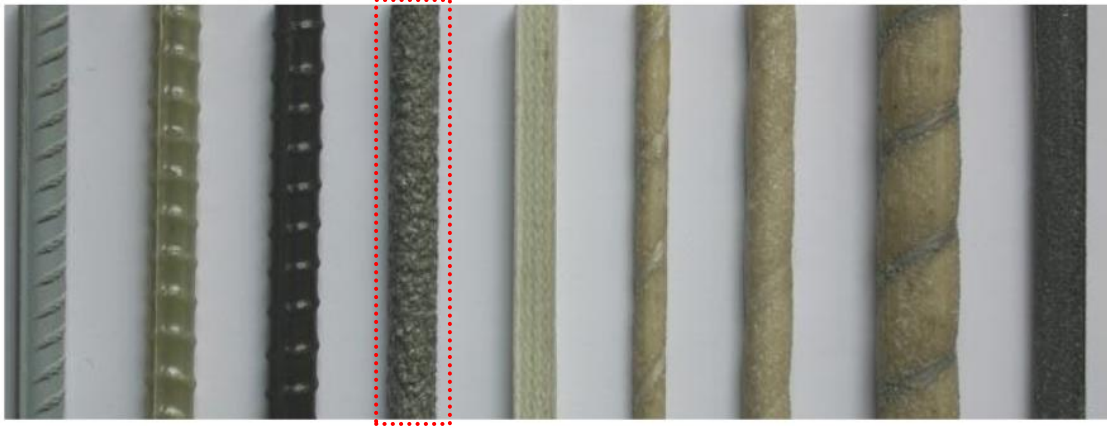
Şekil 2.80. Yapay Donatı Çubukları (Beycioğlu ve Aruntaş, 2014) (Tez kapsamında kullanılan kuşlamalı karbon-fiber donatı çeşidi kırmızı çerçeveye alınmıştır.)
