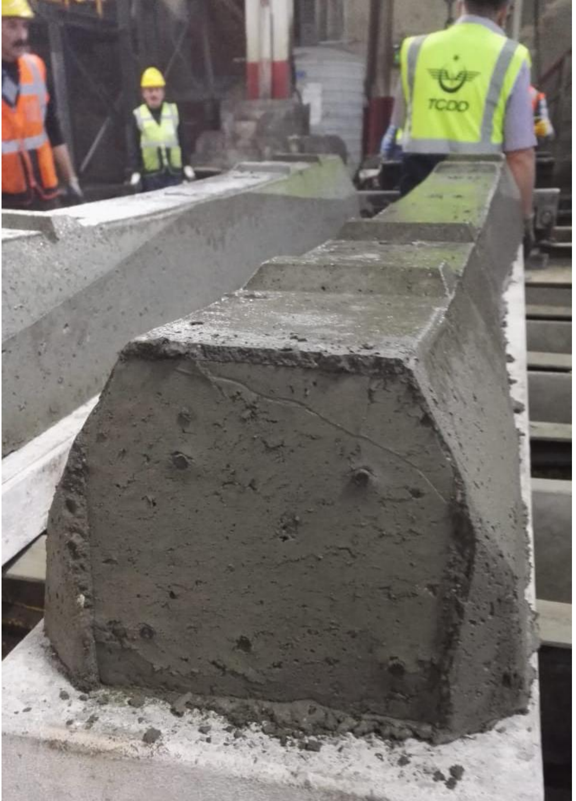
Şekil 3.5. Hazırlanan karbon-fiber donatılı prototipin taze beton formundaki görünüşü
