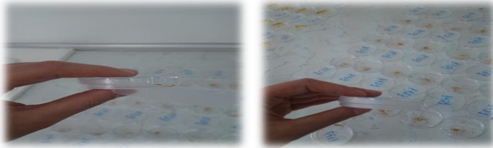
Şekil 3.7. Depolanacak olan anter ve çiçek tozlarının bulunduğu petrilerin ağzlarının parafilm ile kapatılması
