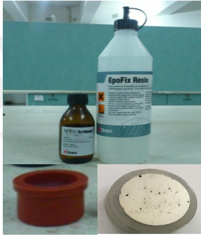
Şekil 3.8. Kalıplama işleminde kullanılan kalıp malzemeleri ve kalıplanmış örnek numune
