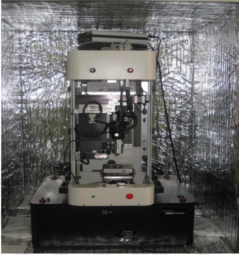
Şekil 3.31. Malzemelerin mekanik karakterizasyonunun yapıldığı nano-çentik cihazı (UMT/NH-2, Bruker)
