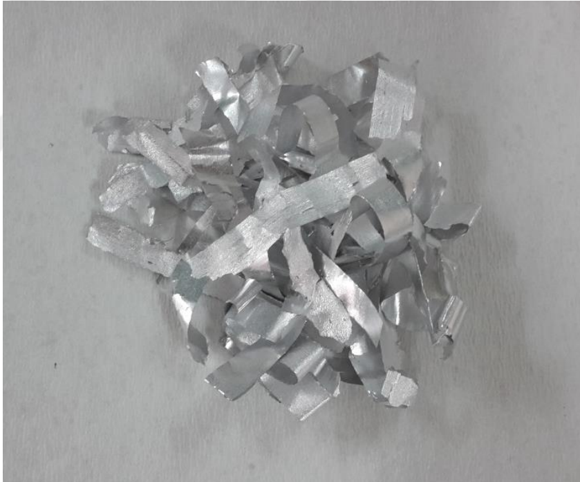
Şekil 3.5. Eriyik eğirme metoduyla, 20 mikron kalınlık ve 1 cm genişlikte üretilen şeritler
