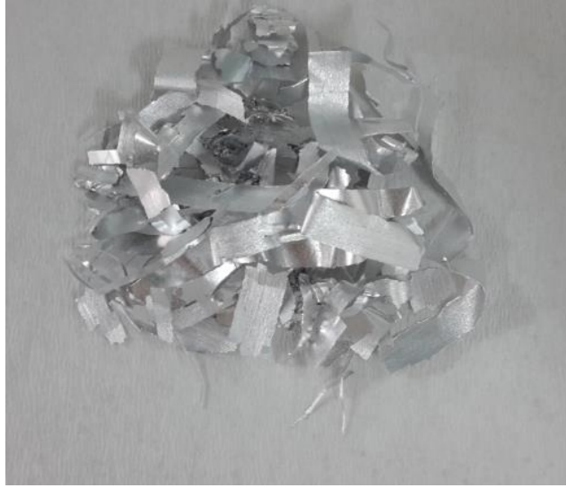
Şekil 2.12. Melt Spinnig (MS) ile eritilerek bükülmüş 20 mikron kalınlığında ve 1 cm genişliğinde Al-5Cu-1Sc katkılı şerit alaşımı
