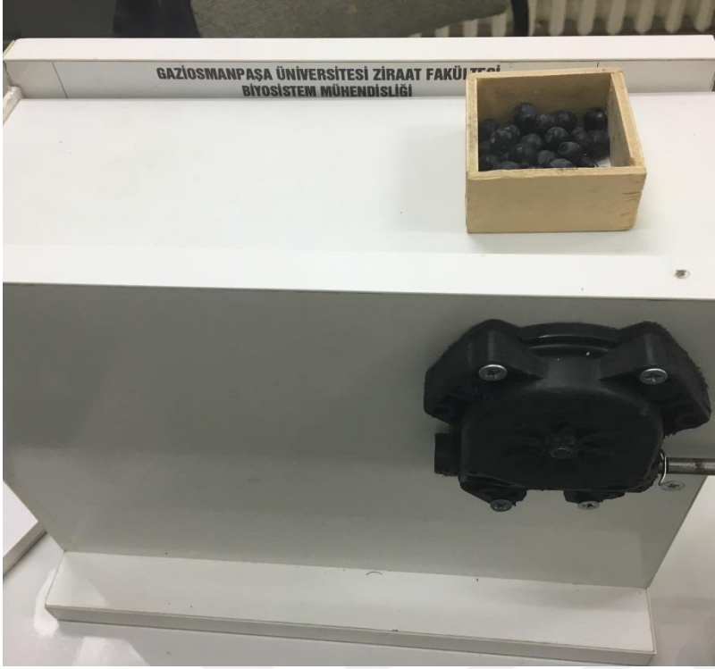
Şekil 3.4. Sürtünme katsayılarının belirlenmesinde kullanılan düzenek
