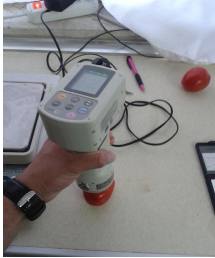
Şekil 3.9. Renk değerlerinin belirlenmesinde kullanılan renk ölçer
