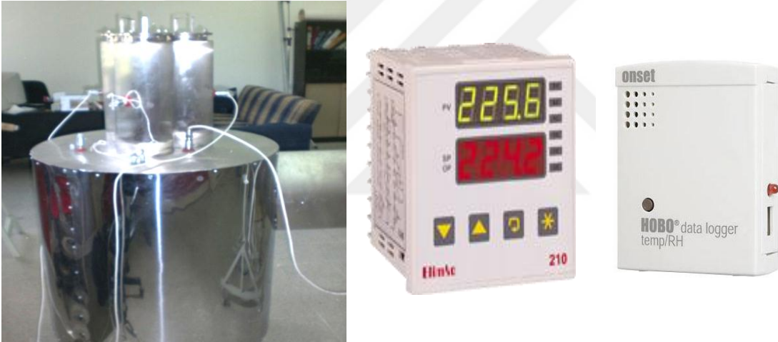
Şekil 3.7. Sıcaklık ölçüm noktaları, kontrol ünitesi, sıcaklık ve bağıl nem kaydedici
