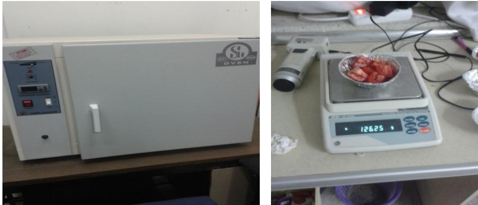
Şekil 3.6. Nem tayininde kullanılan etüv ve hassas terazi
