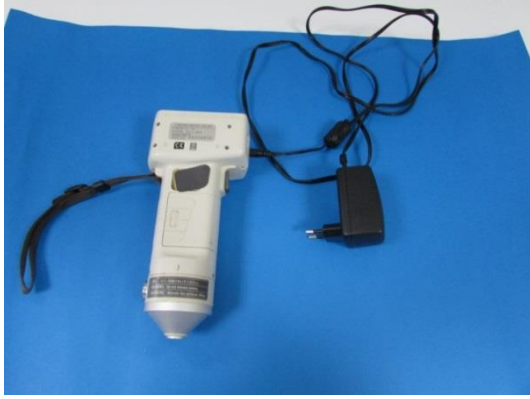
Şekil 3.5. Minolta renk ölçme cihazı CR-400 modeli
