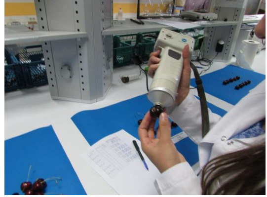
Şekil 3.6. Minolta renk ölçme cihazı yardımıyla meyve renk tayini işlemi
