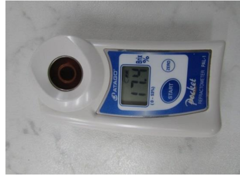
Şekil 3.12. Dijital refraktometre ile SÇKM miktarının ölçülmesi
