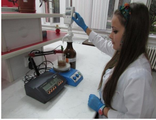
Şekil 3.9. Meyvelerin titrasyon asitliği ve pH değerlerinin pH metre yardımıyla ölçülmesi
