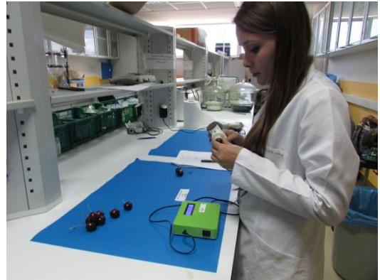
Şekil 3.8. Meyve eti sertliği ölçümü işlemi
