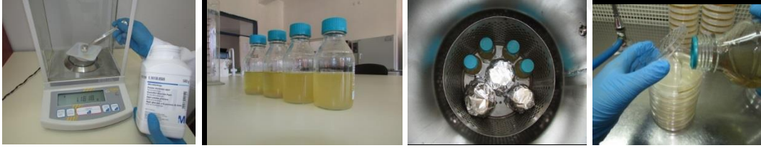
Şekil 3.20 PDA besiyeri hazırlanma işlemi
