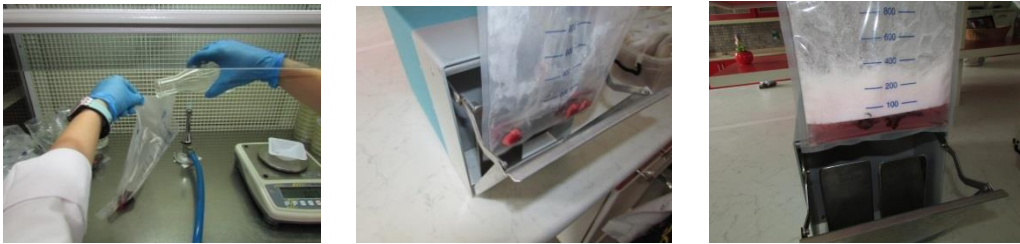
Şekil 3.15. Stomacher'de homojenize edilerek 10^{-1} seyrelti çözeltisi hazırlama işlemi
