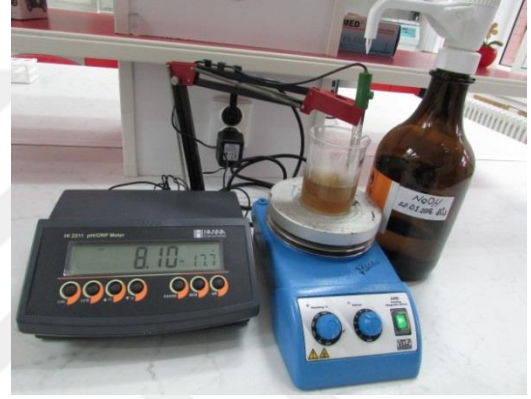
Şekil 3.9. Meyvelerin titrasyon asitliği ve pH değerlerinin pH metre yardımıyla ölçülmesi
