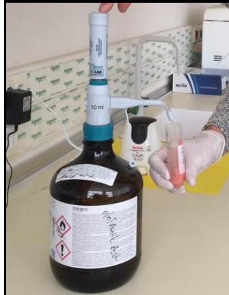
Şekil 3. 13.% 1'lik asetik asitli asetonitril(a) ve magnezyum sülfat + sodyum asetat (b) eklenmesi
