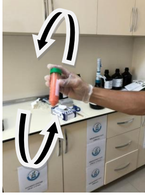
Şekil 3. 14. El ile çalkalama işlemi(a), Santrifüj işlemi (b), Santrifüj sonrası üst faz (c) (50 ml'lik falkon tüpler)
