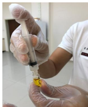
Filtrelenmiş fazın vialle aktarılması(b)
