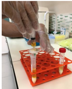
Şekil 3. 16. Şırınga ile üst fazın filtrelenmesi(a)
