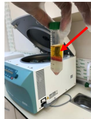
Şekil 3. 14. El ile çalkalama işlemi(a), Santrifüj işlemi (b), Santrifüj sonrası üst faz (c) (50 ml'lik falkon tüpler)
