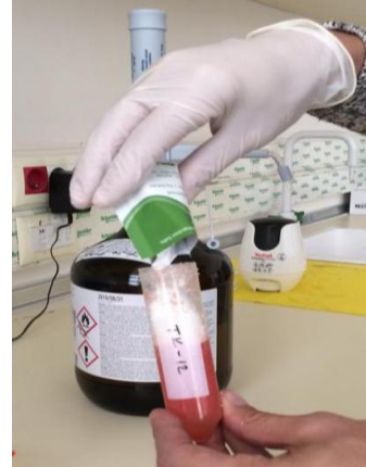
Şekil 3. 13.% 1'lik asetik asitli asetonitril(a) ve magnezyum sülfat + sodyum asetat (b) eklenmesi
