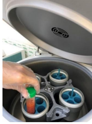
Şekil 3. 14. El ile çalkalama işlemi(a), Santrifüj işlemi (b), Santrifüj sonrası üst faz (c) (50 ml'lik falkon tüpler)
