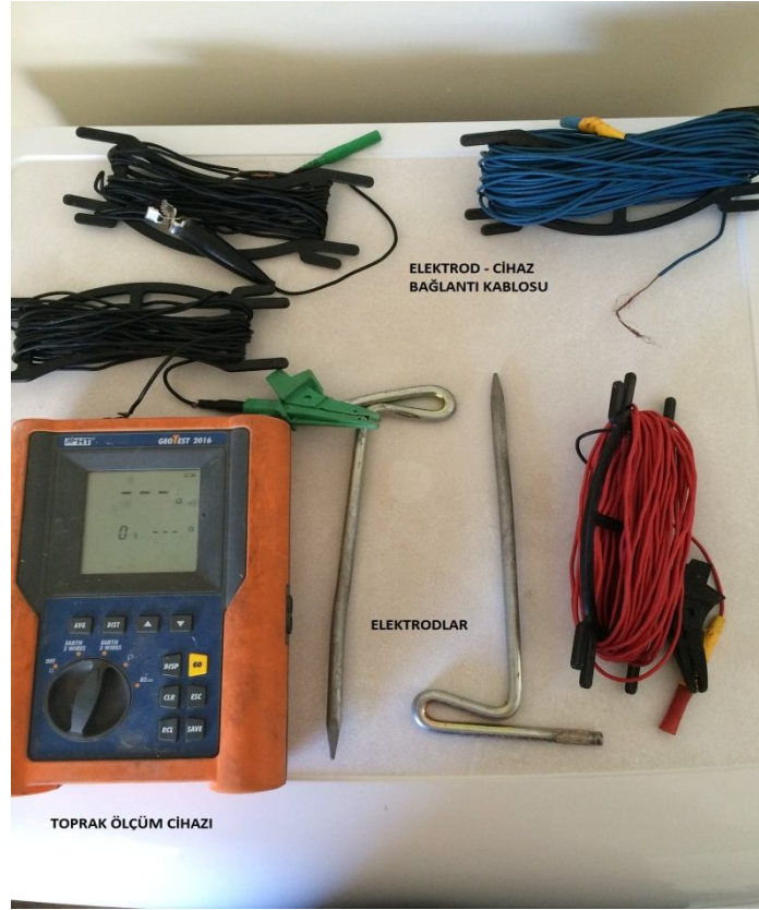
Şekil 5.3: Toprak spesifik direncinin ölçümünde kullanılan ekipmanlar
