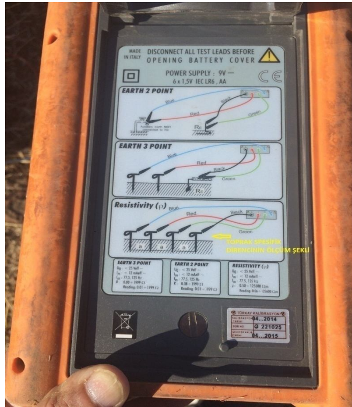
Şekil 5.4 : Toprak spesifik direncinin ölçüm şekli
