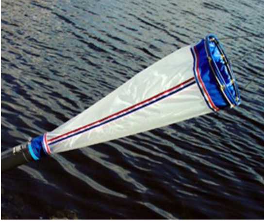
Şekil 3.3 Nansen tipi Plankton Kepçesi
