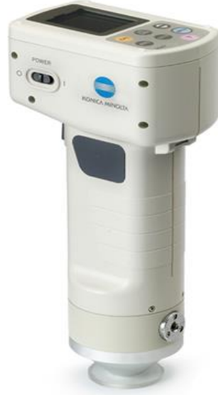
Şekil 3.10. Renk değerlerinin belirlenmesinde kullanılan renk ölçer
