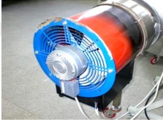
Şekil 3.3. Laboratuvar tipi deneysel kurutucuda fan ve ısıtıcı ünitesi
