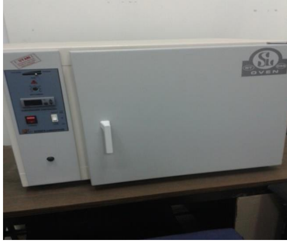
Şekil 3.6. Nem tayininde kullanılan kurutma dolabı (etüv)
