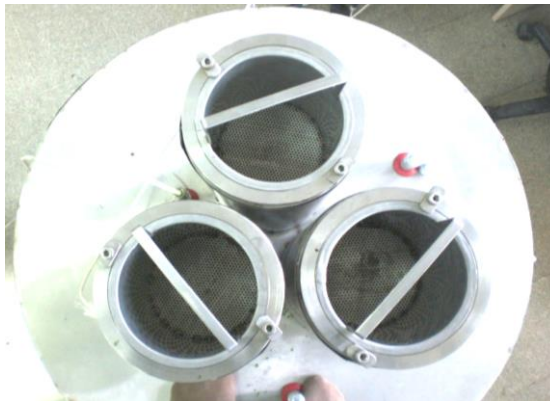
Şekil 3.4. Laboratuvar tipi deneysel kurutucuda kurutma bölmeleri
