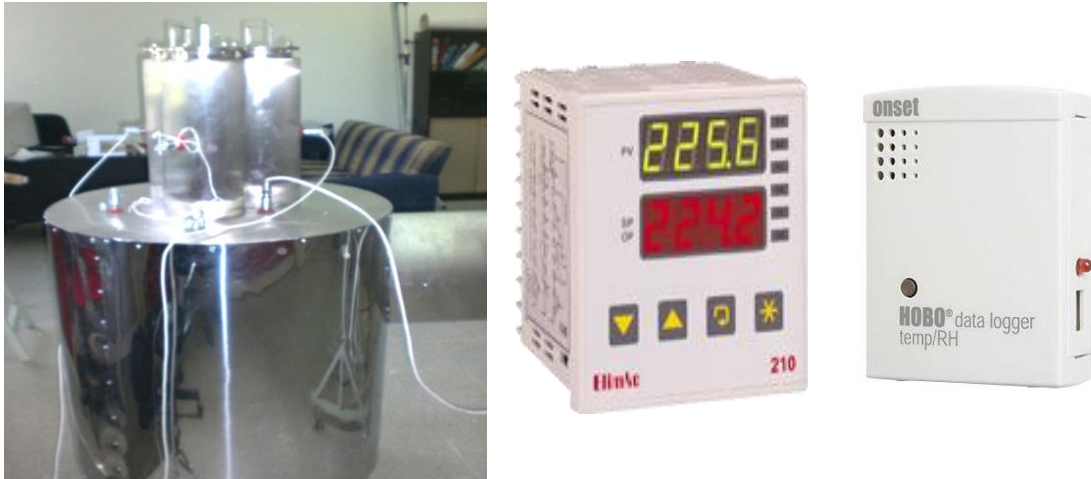
Şekil 3.9. Sıcaklık ölçüm noktaları, kontrol ünitesi, sıcaklık ve bağıl nem kaydedici
