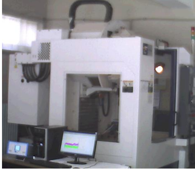
Şekil 3.2. CNC dik işleme merkezi ve dinamometre bağlantısı
