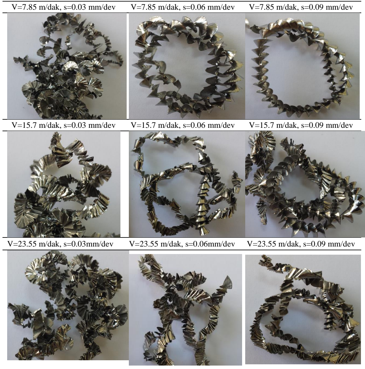
Şekil 4.12. Deney parametrelerinden elde edilen talaş örnekleri
