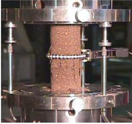
Şekil 3.8. Silindirik Tuğlanın Çevrimli Basınç Deneyi ve Tipik Gerilme-Şekil Değişirme Eğrisi
