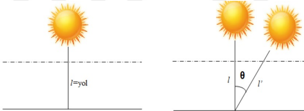
Şekil 2.4. Güneş ışınımının atmosferi geçerken aldığı yolun değişimi
