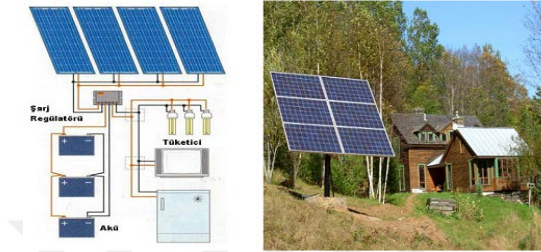
Şekil 2.10. Şebekeden bağımsız (ada) sistemler
