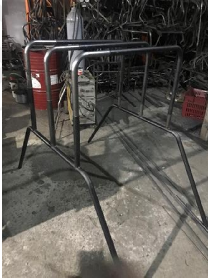
Şekil 3.6. Platform METAZİ'nin şasi kısmı (Tarla tipi barı ile birlikte)
