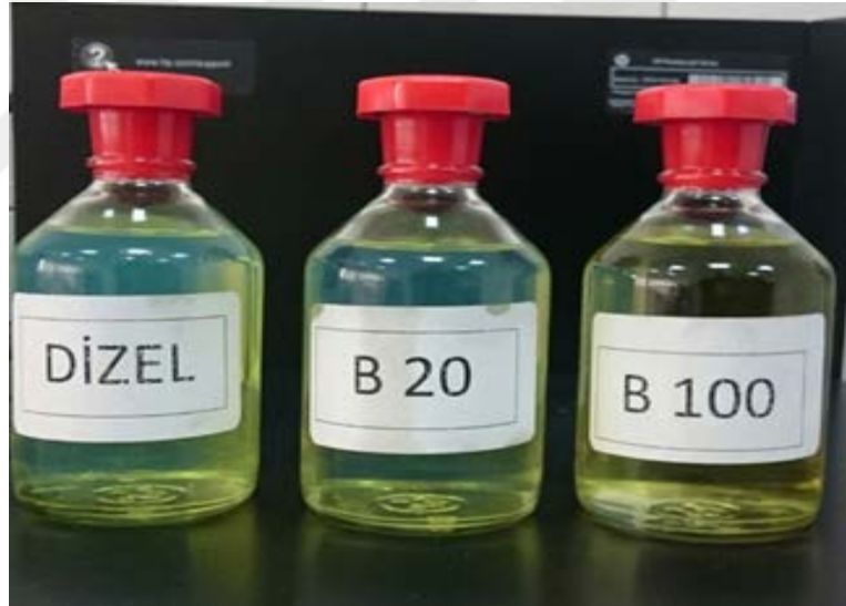
Şekil 3.8. Motor testlerinde kullanılan yakıtlar
