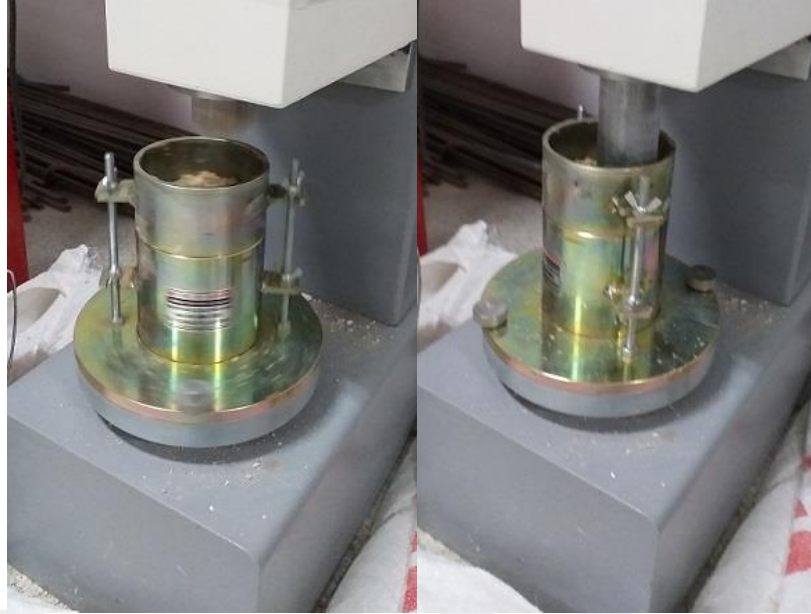
Şekil 3.12 Modifiye proktor deney aşamaları-2
