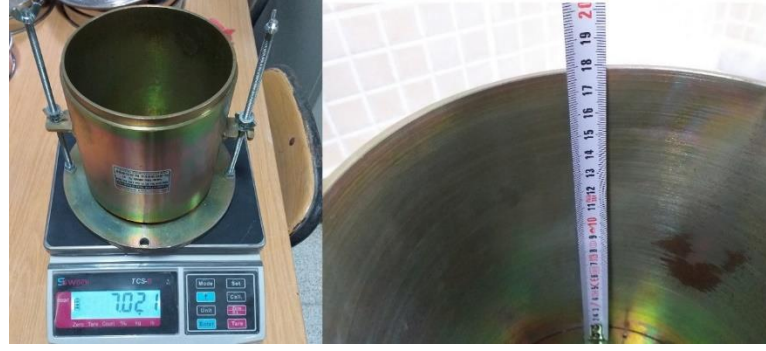
Şekil 3.13 Taban plakası takılı CBR deney kalıbı ve yükseklik ölçüsü
