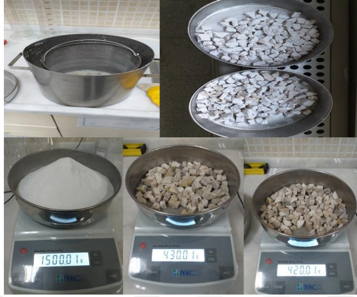
Şekil 3.2 MgSO 4 ile hava tesirlerine karşı dayanıklılık deney aşamaları
