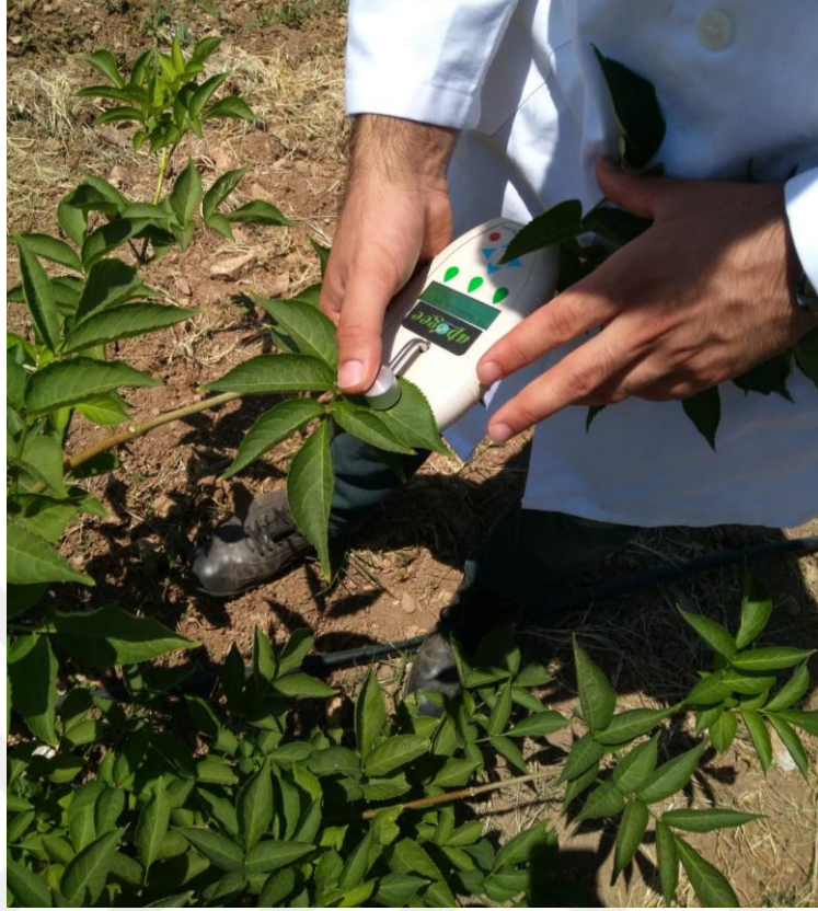
Şekil 3.9. Yaprak klorofil değeri ölçümü (Orijinal)
