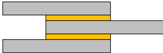
Şekil 2.3 Çift bindirme bağlantı (Double lap joint )
