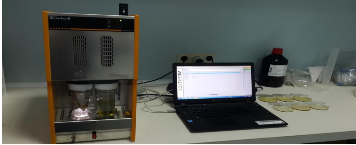
Şekil 3.8. Özütleme işlemi için kullanılan basınçlı ekstraksiyon cihazı
