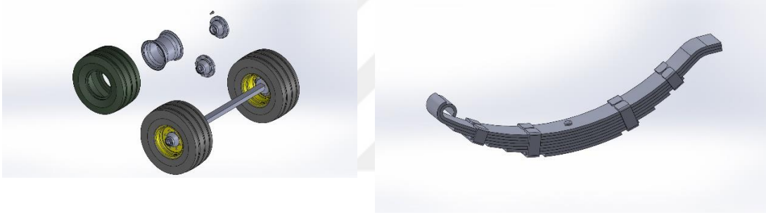
Şekil 4.6. Yağış simülatörü lastik tekeri ve yay sistemi
