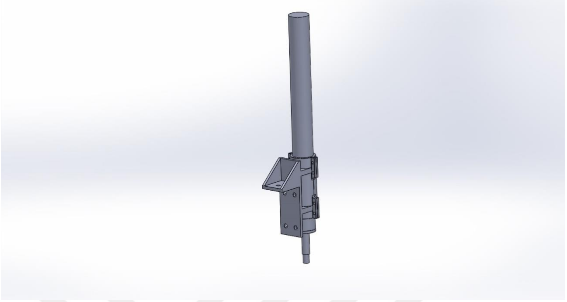
Şekil 4.10. Hareketli kapağı yönlendiren hidrolik piston
