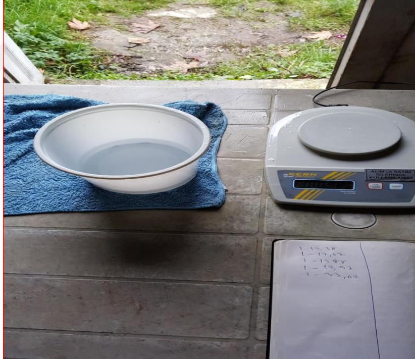
Şekil 3.5. Balık tartım cihazı 0.1mg KERN ABJ (Orijinal)
