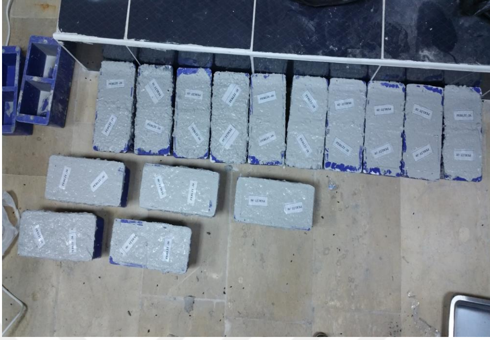
Şekil 9 Betonun Numunelere Yerleştirilmesi
