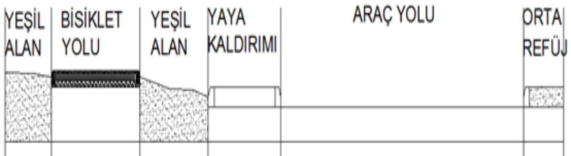
Şekil 3.6. Taşıçiftlik yerleşkesi genelinde uygulanacak bisiklet yolu, yaya yolu ve araç yolu en kesiti
