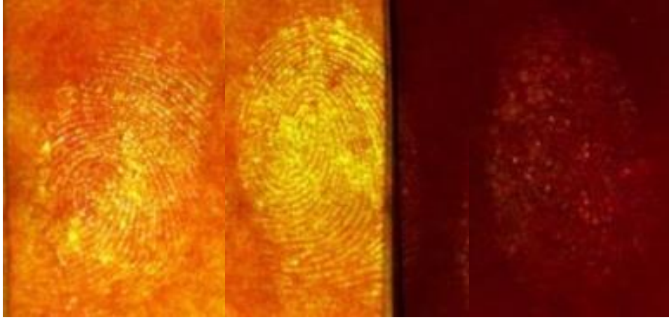
Şekil 4.42. 57 No' lu bileşik (solda) ve lawson 4 (sağda) çözeltileri ile muamele edilen termal fatura kağıdında gelişen parmak izlerinin fotoluminesans modda çekilen fotoğrafları
