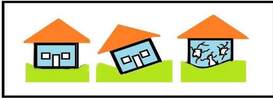
Şekil 3.37. Mühendislik yapılarında ortaya çıkan oturma
