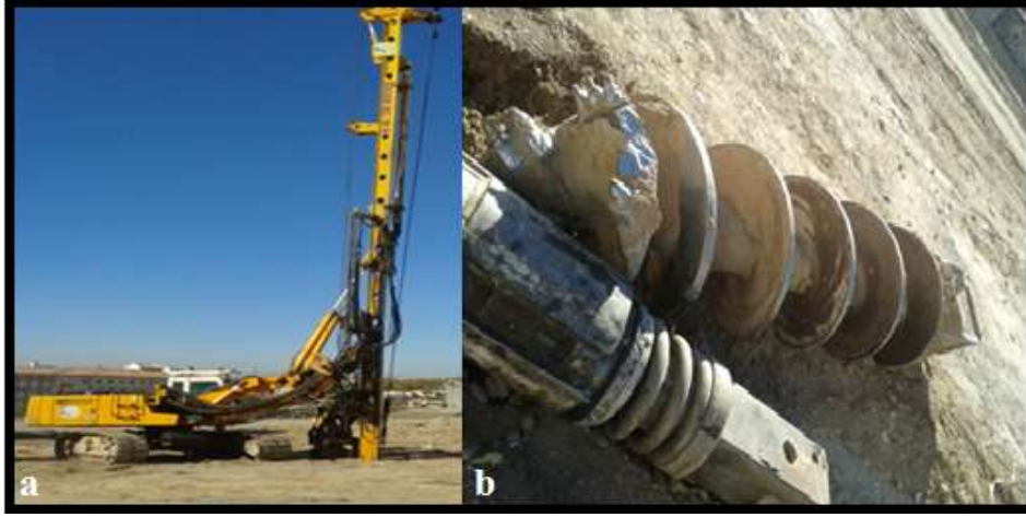
Şekil 3.47. a) Fore kazık makinası b-) Delme işleminde kullanılan matkap ucu ve aparatı
