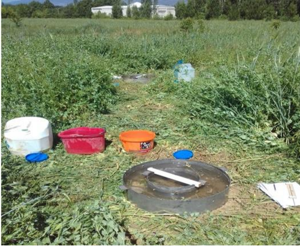
Şekil 3.3. Çalışma alanında yapılan infiltrasyon testinden bir görünüm
