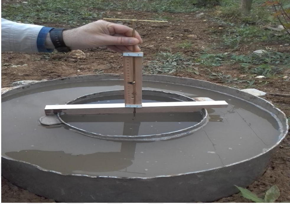
Şekil 3.4. İnfiltrasyon testinde su seviyesinin ölçümü
