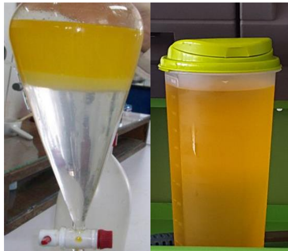
Şekil 3. 3. Yıkama işlemi sonrası ayırıştırma ve kullanılabilir biyodizel
