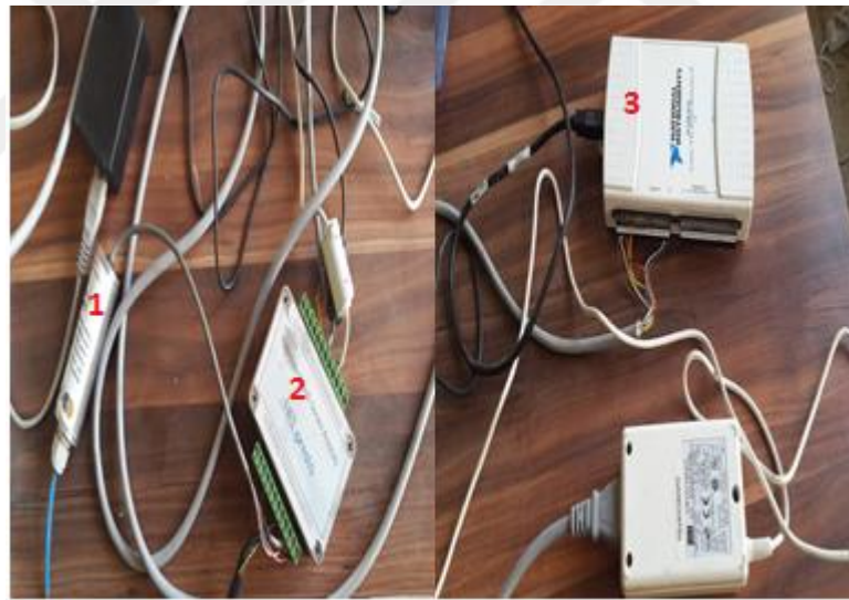
Şekil 3. 6. Basınç Sensörü Sinyal Koşullandırıcısı(1), sensör arayüzü(2), veri toplama kartı(3)
