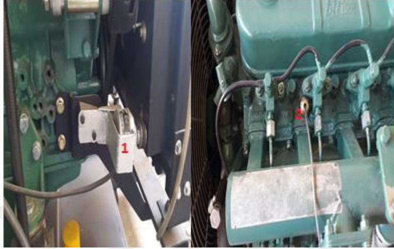
Şekil 3. 5. Krank açısı enkoderi (1) ve basınç sensörü montajı (2)
