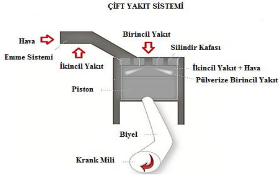
Şekil 1. 9. Örnek çift yakıt sistem çalışması (Anonymous, 2014)
