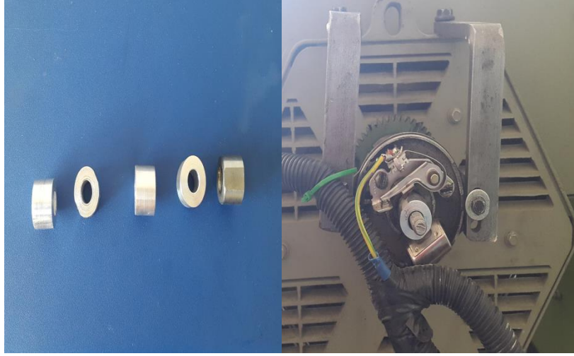
Şekil 3. 8. Üretilen burçlar ve montajı
