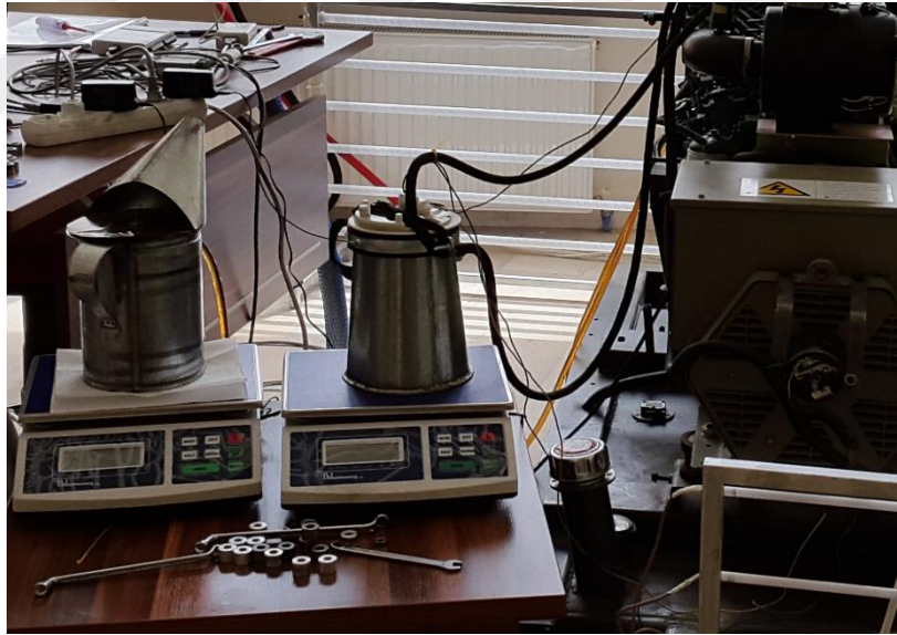
Şekil 3. 9. Yakıt tankları ve teraziler
