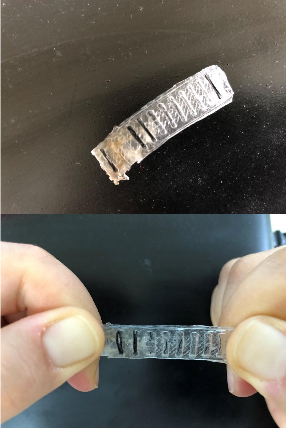
Şekil 4.7. 70/30 kopolimeri kullanılarak basımı gerçekleştirilen kelepçe görselleri
