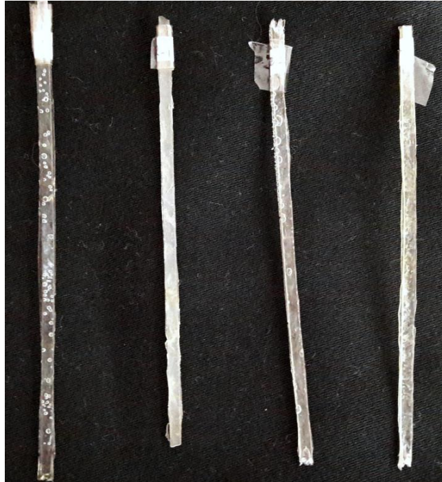
Şekil 3.4. Sentezlenen kopolimerler ile hazırlanan 5x1x100 mm boyutlarındaki örnekler
