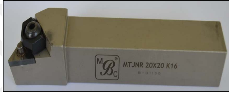
Şekil 3.6. Kesici takım tutucu
