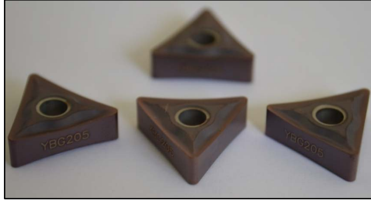
Şekil 3.5. TiAlN PVD kaplı Sementit Karbür kesici takım
