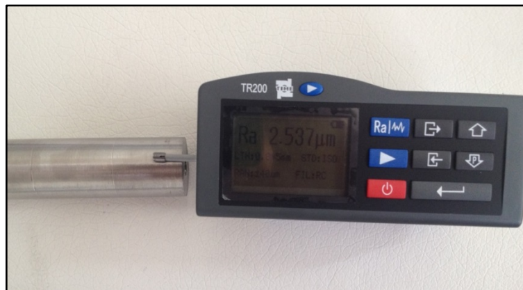
Şekil 3.7. Yüzey pürüzlülük ölçüm cihazı
