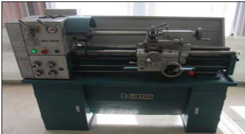
Şekil 3.2. Deneysel çalışmada kullanılan üniversal torna tezgâhı
