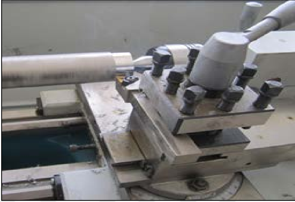
Şekil 3.3. İş parçasının tornada işlenmesi
