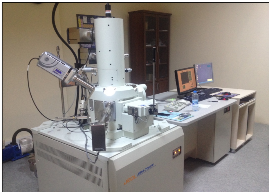
Şekil 3.9. Tarama elektron mikroskobu
