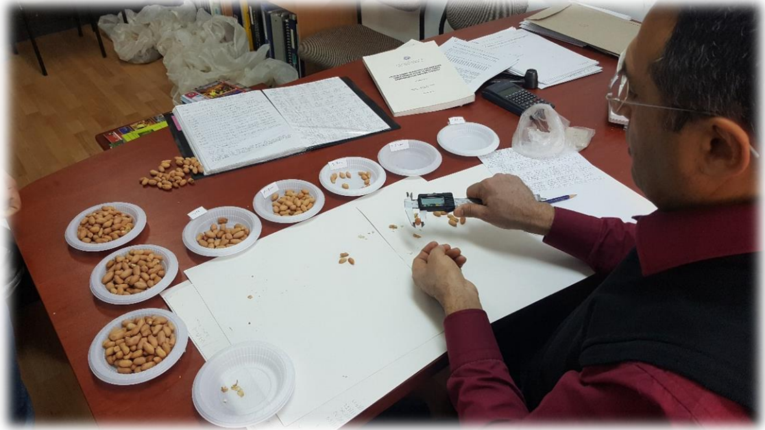
Şekil 3.17. Kumpas ile yer fıstığı içlerinin çap ölçümü ve sınıflandırılması
