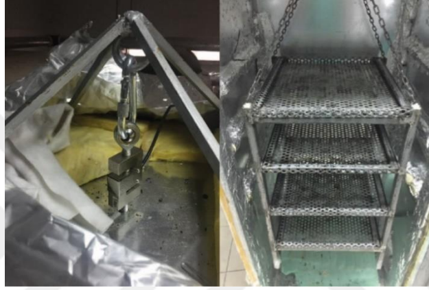
Şekil 3.16. Titreşim sönümlenme montaj kiti olmadan yük hücresinin montajı
