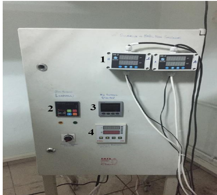
1. Hava Sıcaklığı ve Bağıl Nem Dijital Göstergeleri 2. Yük Hücresi Sinyal Dönüştürücüsü ve Göstergesi 3. Dijital Potansiyometre 4. PID Kontrol Ünitesi (Elimko E-210)
