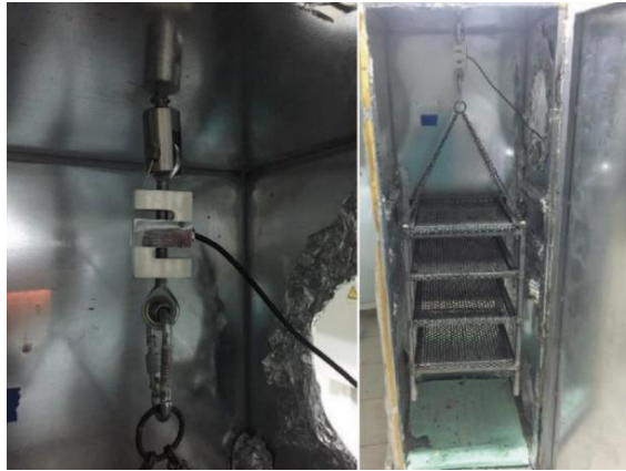
Şekil 3.17. Titreşim sönümlenme montaj kiti kullanılarak yük hücresinin montajı
