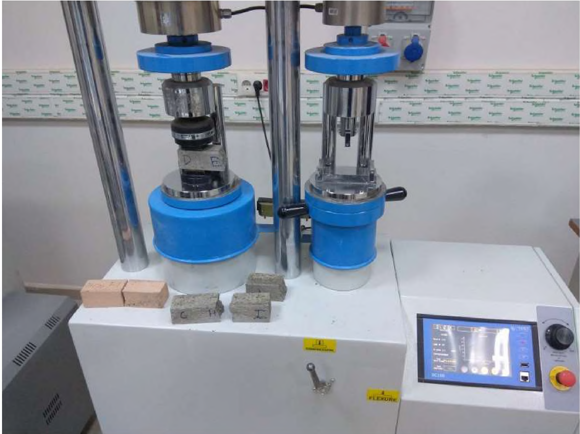
Şekil 3.12 Eğilme ve basınç deneyleri için kullanılan elektronik deney presi
