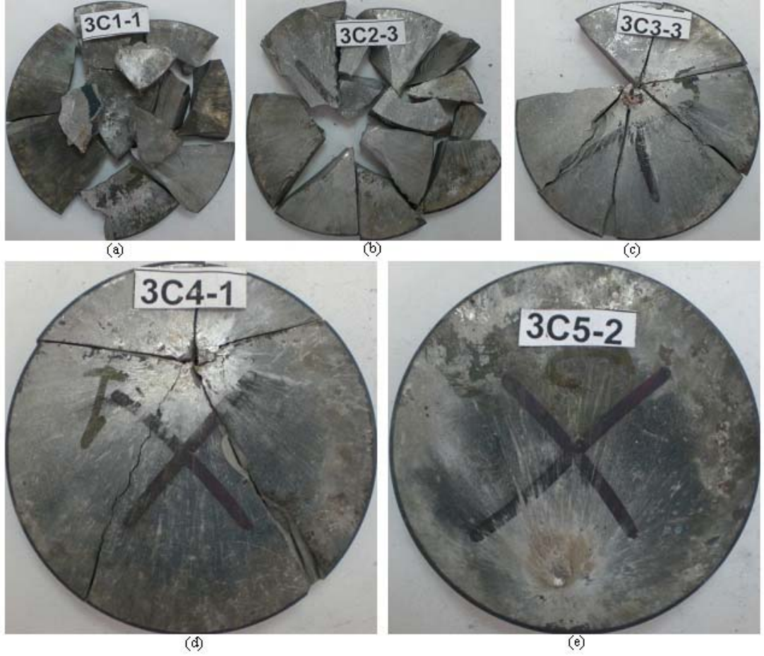
Şekil 5.3.17. 3C numunelerinin en düşük alan yoğunluğundan (a) en yüksek alan yoğunluğuna (e) doğru sıralanmış balistik deneyler sonucundaki ön yüz görüntüleri. 5. alan yoğunluğu hariç tüm numuneler delinmemiş ancak kırılarak başarısız olmuştur (a b, c ve d). 5. Alan yoğunluğunda yalnızca bir numune başarılı olmuştur. (e)
