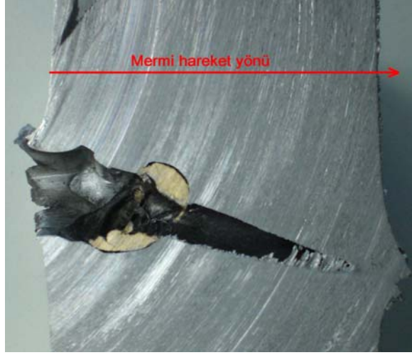
Şekil 5.4.5. Sünük alüminyum numunesi 6A'da mermi hareket yönünde bakır gömlek sıyrılması sonucu kesit daralması ve yine aynı nedenden mermi giriş bölgesindeki şişmenin gösterimi.
