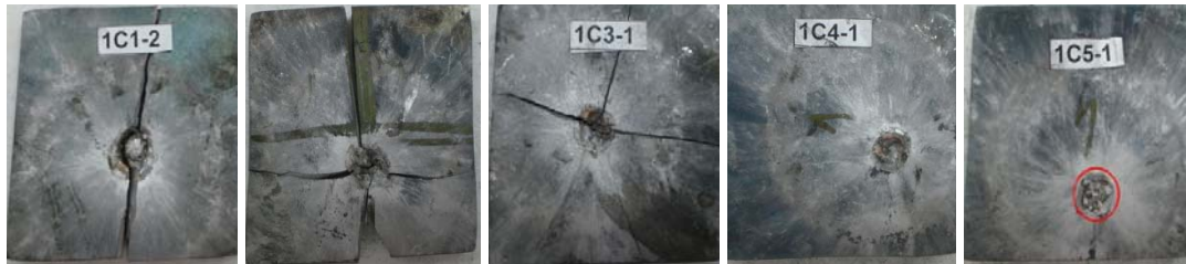
Şekil 5.3.4. 1C numunelerinin deney sonrası görüntüleri. 4. ve 5. alan yoğunluklarında bakır gömleğin sıyrıldığı bölge kırmızı daire içinde gösterilmiştir. (Soldan sağa sırasıyla 1., 2., 3., 4. ve 5. alan yoğunluklarındaki numuneler.)
