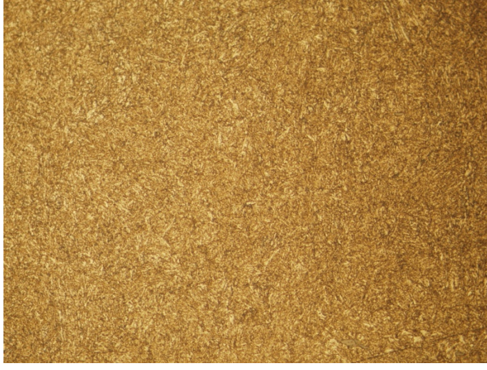
(a) 40 HRC sertlik, östenitleme sıcaklığı 860°C, Menevişleme sıcaklığı 560°C ve süresi 2 saat. X 200, 15 s dağlama süresi, %5'lik nital dağlayıcı.
