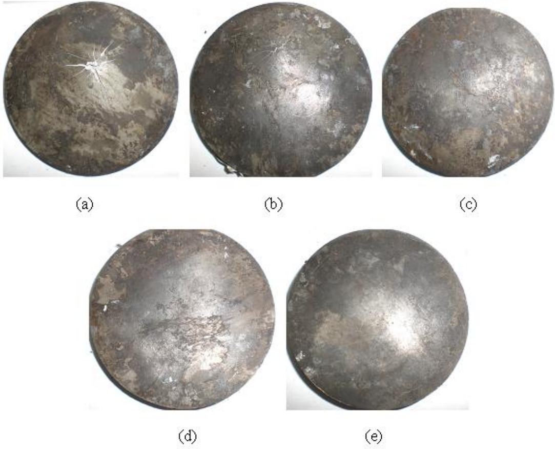
Şekil 5.3.24. 4C grubu numuneler için balistik deneyler sonrası arka yüz görüntülerinin sunulması. En düşük alan yoğunluğundan (a), en yüksek alan yoğunluğuna doğru sıralanmış numuneler. İlk iki alan yoğunluğunda arka yüzde beliren çatlaklar görülmektedir.
