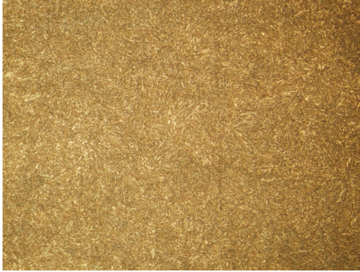
(b) 50 HRC sertlik, östenitleme sıcaklığı 860°C, Menevişleme sıcaklığı 450°C ve süresi 2 saat. X200, 15 s dağlama süresi, %5'lik nital dağlayıcı.
