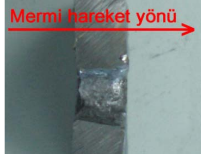
Şekil 5.4.4. Gevrek delinen 2B numunesinde mermi giriş bölgesinde sıyrılmanın etkisinin olmadığını ve çıkış yönünde genişlemenin gösterilmesi.
