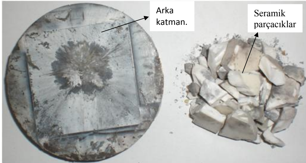
Şekil 5.3.21. Zırh delici mermi çarptıktan sonra katmanlı kompozit zırhın görüntüsü. Seramik katman parçalanıp destek katmandan ayrılırken destek katman balistik korumayı sağlamıştır.
