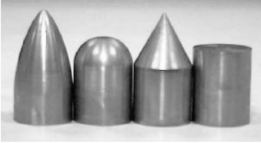
Şekil 3.2.1. Kullanılan mermi geometrileri. Soldan sağa doğru sivri kemerli, yarı küresel, konik ve silindirik mermi geometrileri [25].
