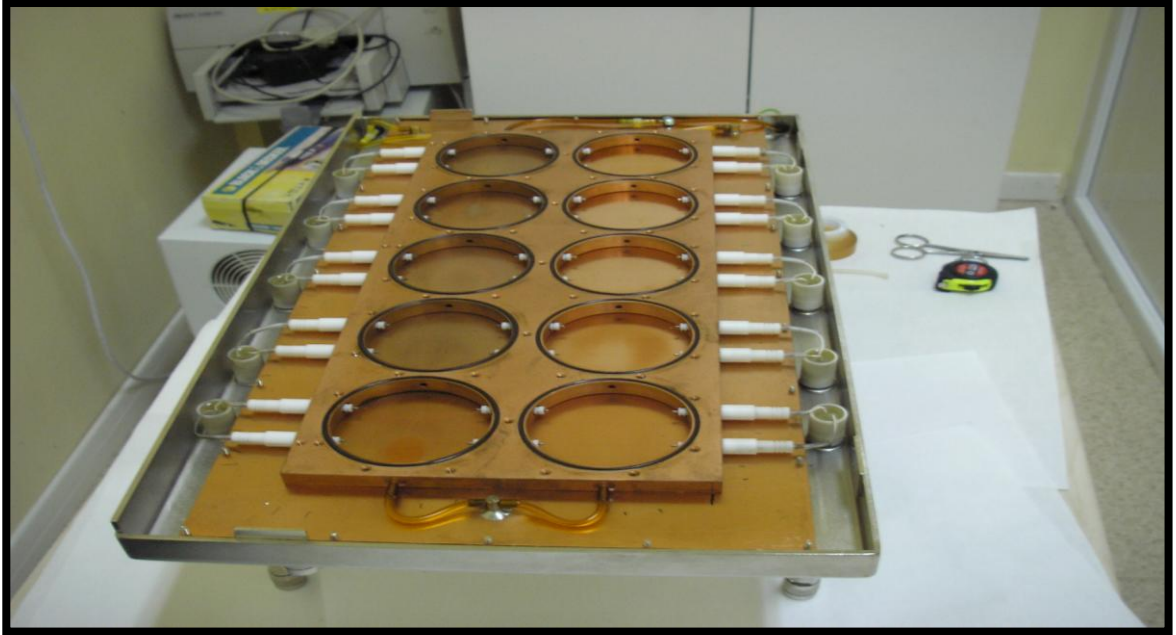
Şekil 2.4. Toplam alfa ve beta ölçüm sisteminin üst görünümü
