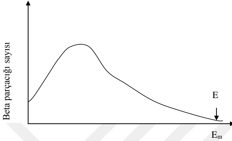
Şekil 1.3. Beta parçacıklarının enerji spektrumu
