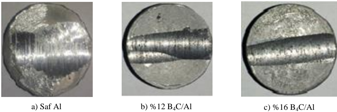
Şekil 4.7.Saf Al ve farklı B_4C takviye oranına bağlı Al matrisli bazı kompozitlerin aşındırılmış görüntüleri
