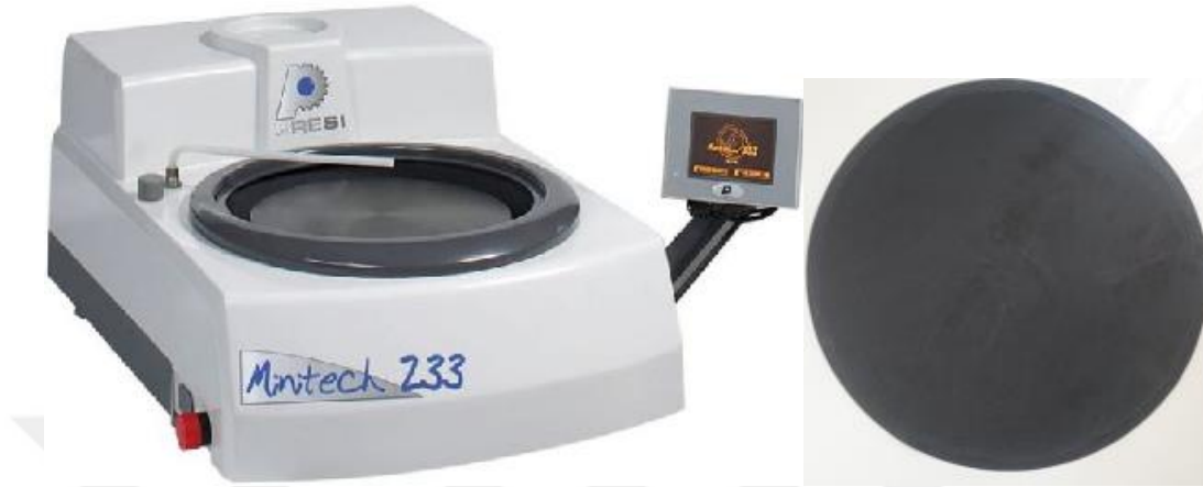
Şekil 3.9. Presi Minitech 233 model parlatma cihazı ve Grit yapışkanlı disk zımpara kâğıdı
