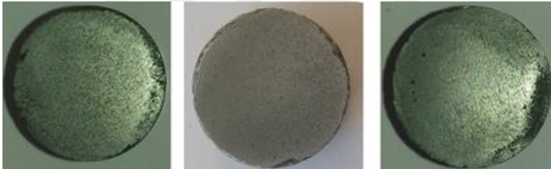
Şekil 3.8. %8 B 4 C/Al numunelerin farklı sinterleme sıcaklıklarındaki görüntüleri
