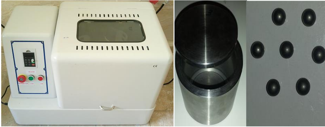
Şekil 3.4. Planetary Ball Mill, XQM-2 mekanik karıştırma cihazı, aparatı ve çelik bilyeler
