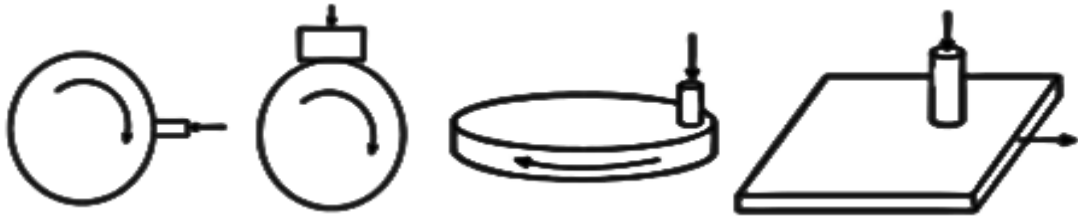
Şekil 2.19. Kayma aşınması için kullanılan geometrik düzenler (Şahin, 2012)
