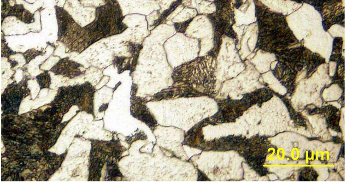
Şekil 4.10. Normalleştirme yapılmış yapının mikroskop görüntüsü, (x1000 büyütme)
