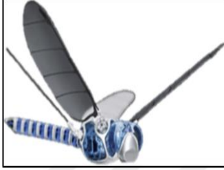
Şekil 2.19. Şekil hafızalı alaşım kullanılarak yapılan yusuçuk
