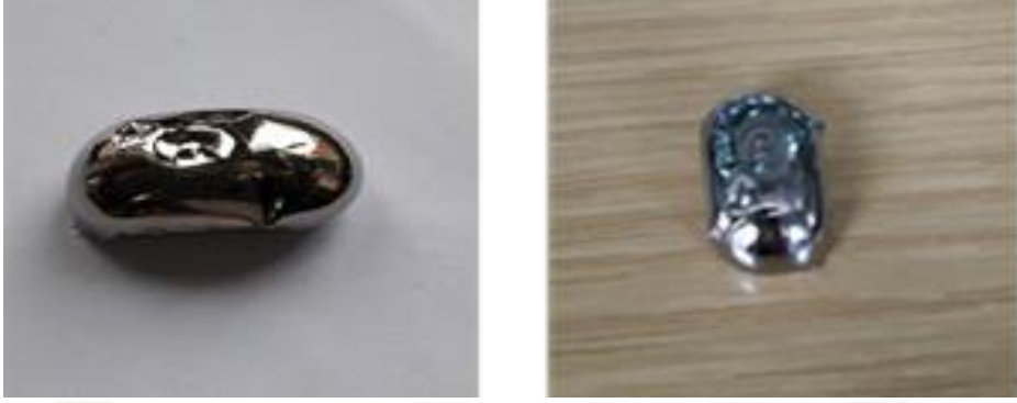
Őekil 3.2. Ark-Eritme (Arc-Melting) tekniđi ile üretilen mastır alařımlar
