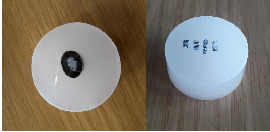
Şekil 3.11. Dağlama işlemi yapılan mastır ve şerit alaşımlar
