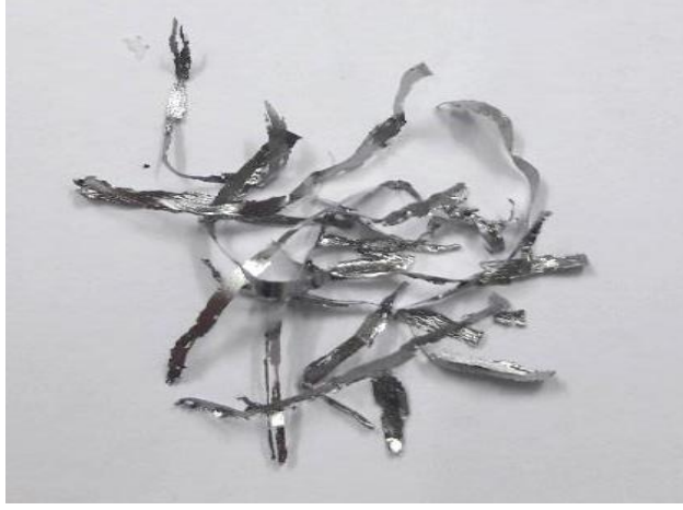
Şekil 3.8. Eriyik-Eğirme (Melt-Spinning) tekniği ile üretilen şerit alaşımlar
