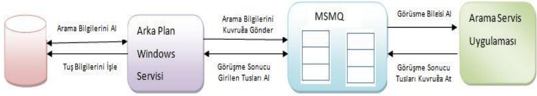
Şekil 5.26 Kuyruk Servis İşlemlerinin Gösterimi
