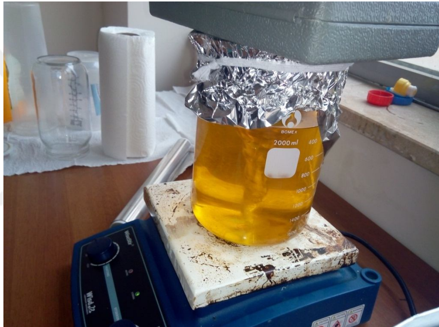
Şekil7.5.Aspir yağının metoksit ile karıştırılması
