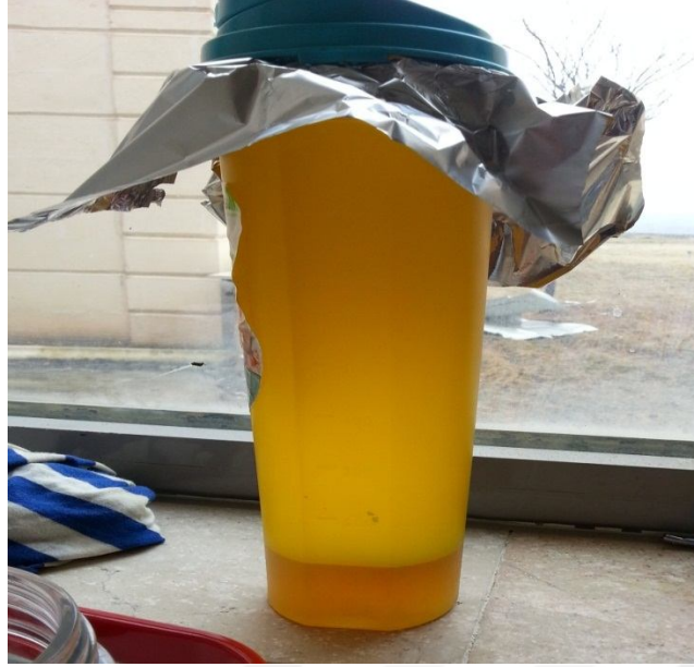
Şekil7.6. Biyodizel içerisindeki gliserolün çökmeye başlaması
