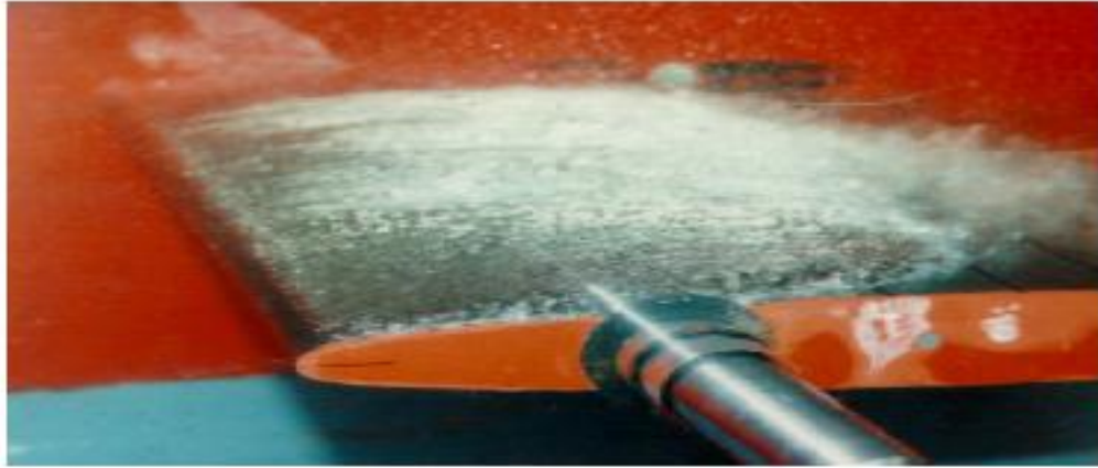
Şekil 3.32 Bulut kaviteasyonuna ait resim. (Çelik, F., Kaviteasyon)
