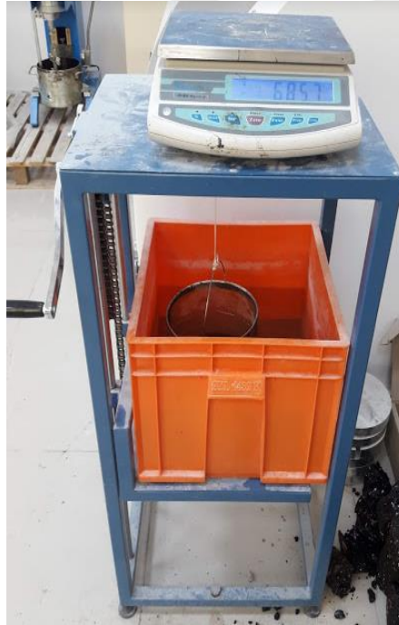
Şekil 3.23. Arşimet terazisinde Marshall numunesinin tartımı
