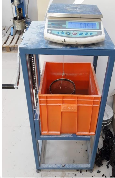
Şekil 3.11. Tel sepet ve sızdırmaz tank
