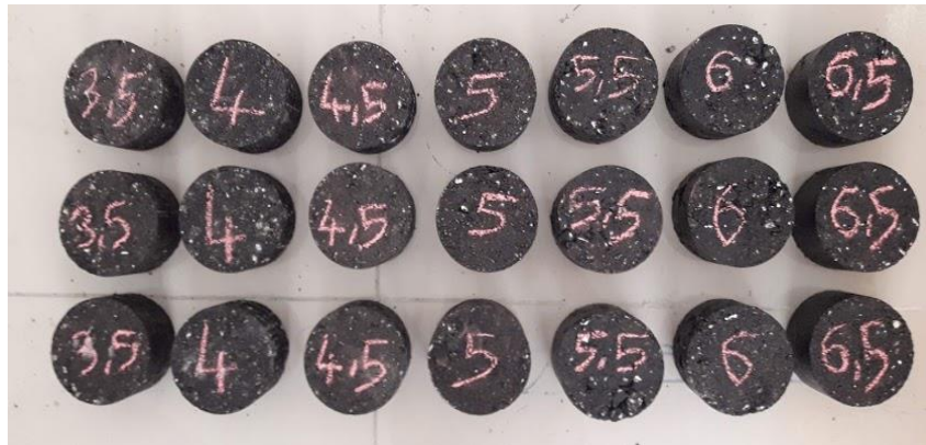
Şekil 3.22. Marshall numunelerinin kalıptan çıkarılmış hali
