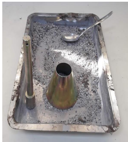
Şekil 3.13. Abraham hunisi ve tokmağı yüzey hale getirilmesi
