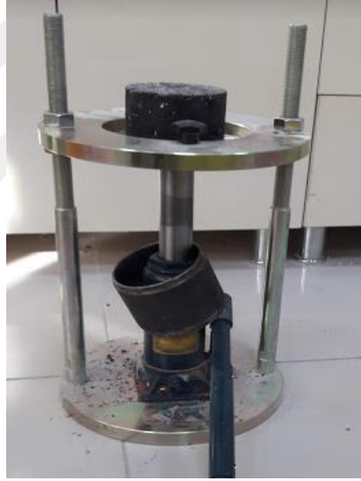
Şekil 3.21. Numunelerin kriko ile kalıptan çıkarılması
