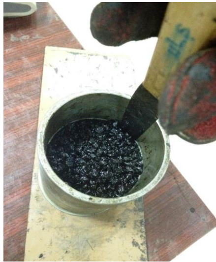
Şekil 3.19. Karışımın kalıba yerleştirilmesi
