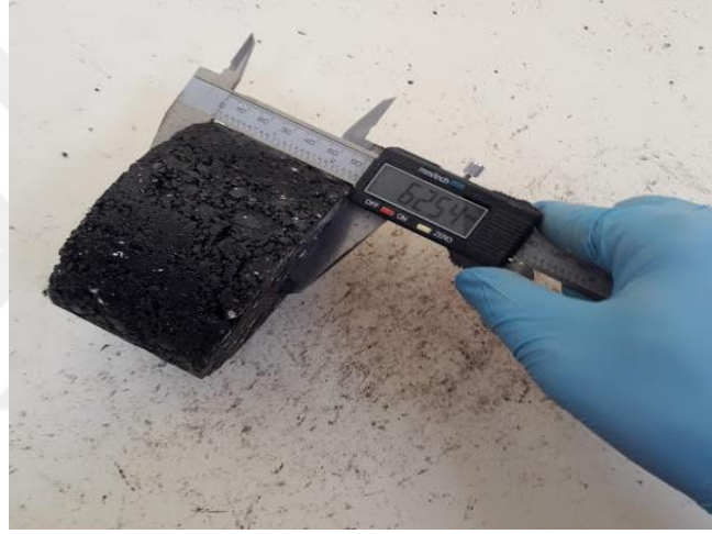
řekil 3.24. Kumpas ile numunenin ölçümü
