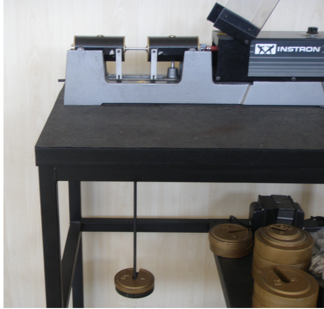
Őekil 5.4: TOBB ET mekanik test laboratuarında bulunun R.R Moore tipi yksek evrim yorulma test cihazı.
